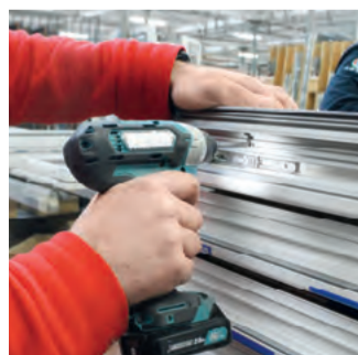
AR.MA. fertigt Kunststoff-Fenster und -Fenstertüren. Im Bild die Montage des Wetterschenkel Komfort von Roto.
