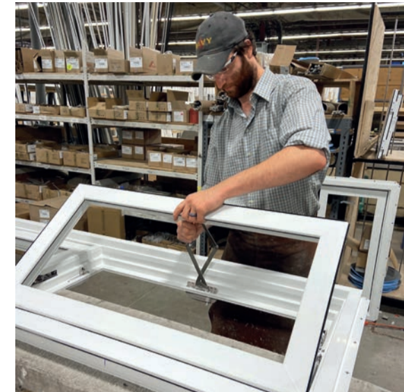
Casement & Awning Fenster mit Roto Beschlägen sind die Spezialität von Zach Carr.
