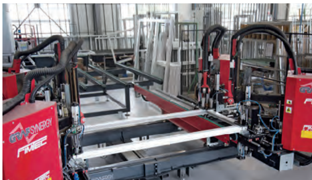
Als erstes Unternehmen in Polen stellte B.FT bereits 2014 auf das automatische Formschweißen von Fensterprofilen um.
