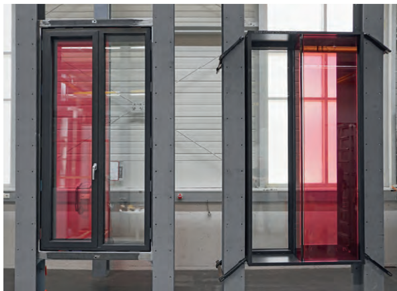
Testaufbau zweier Fassadenelemente für das AXA Belmont Gebäude in Brüssel im Roto ITC Leinfelden: Farbige VSG-Fassadenplatten stehen in der Fassade vor den mit AL Designo gefertigten Drehfenstern der Widerstandsklasse RC 2.
